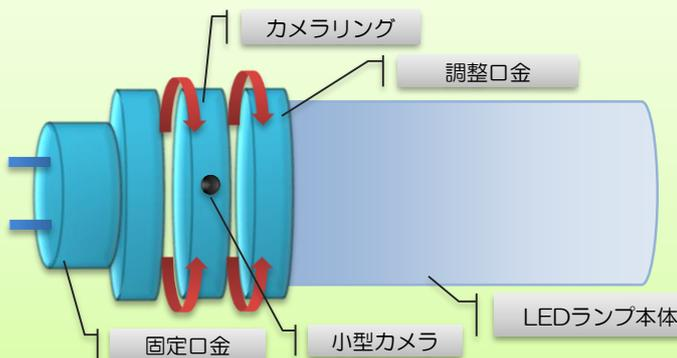
2重リング構造によりカメラと照明の角度を独立して調整可能。
